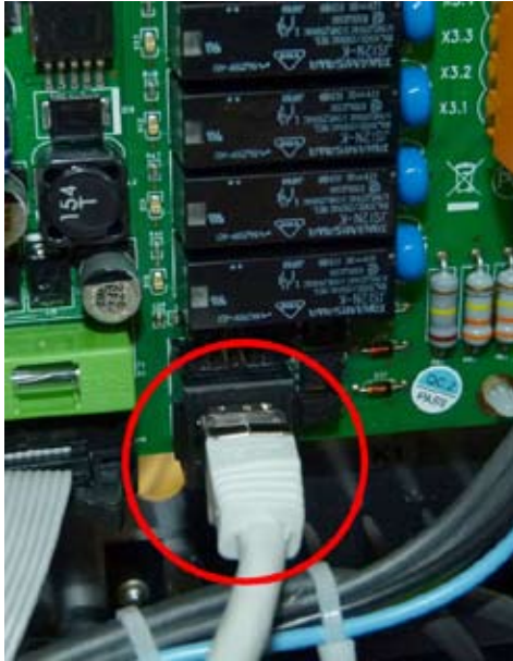
Rys. 1 - Złącze szeregowe linii RS 485 na źródle
