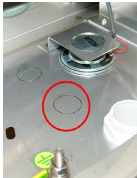
Rys. 4: Otwór do montażu przepustu z kablem UT
