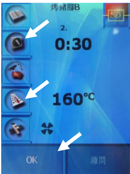
设定时间 30 分温度 160 度 C 湿度 50%后按 OK，第 2 步骤设定完成
