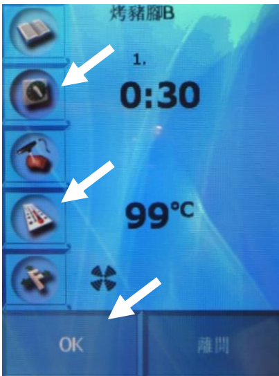
设定时间 30 分温度 99 度 C 后按 OK，第 1 步骤设定完成
